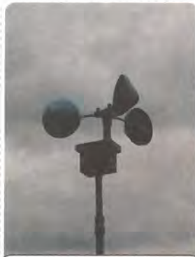
الأنيمومتر لقياس سرعة الرياح.
